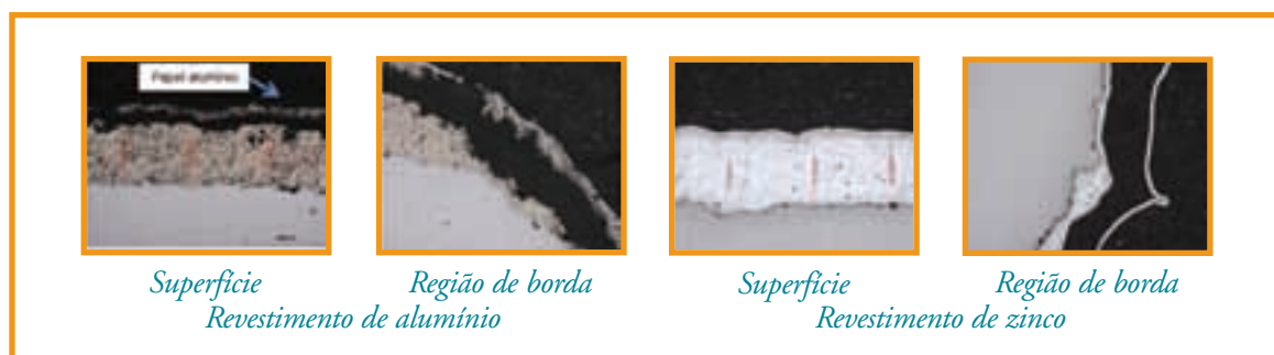
Figura 2 – Aspecto micrográfico da seção transversal de corpos de prova revestidos com alumínio ou com zinco
