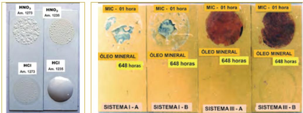
Figura 6 - Corpos de prova após ensaios de imersão com “Spot test” em diversos líquidos
