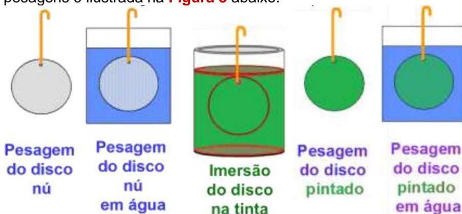
**Figura 3 – Desenho da sequência de pesagens do disco em água e na tinta**
