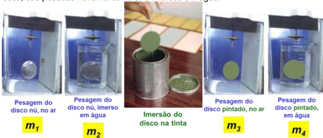
**Figura 4** – Fotos da sequência de pesagens do disco em água e na tinta
