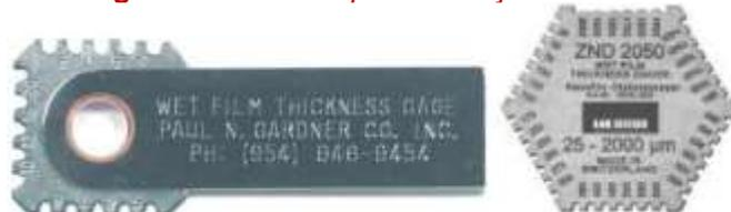
**Figura 10** – Estes medidores são precisos e resistem ao desgaste por serem de aço inox
