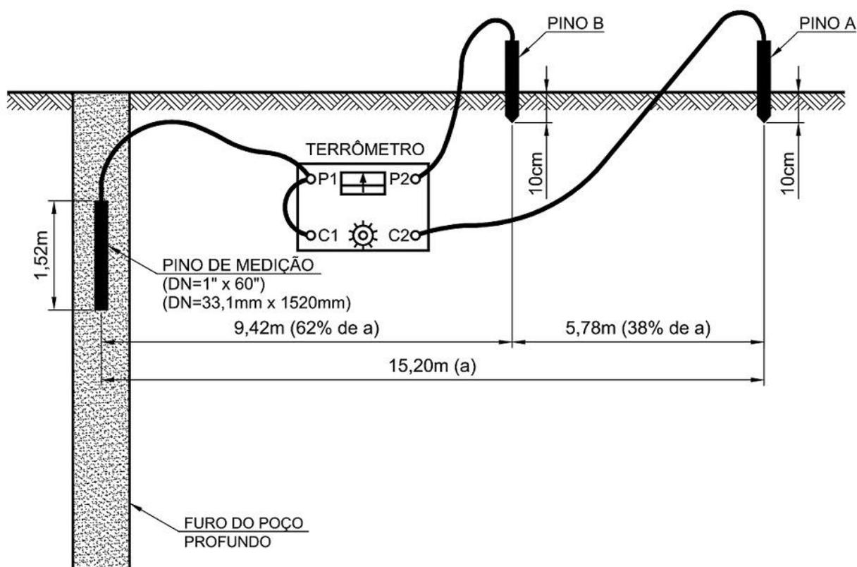
Fig. 1 – Esquema de um furo profundo para medição de resistividade elétrica do solo.
