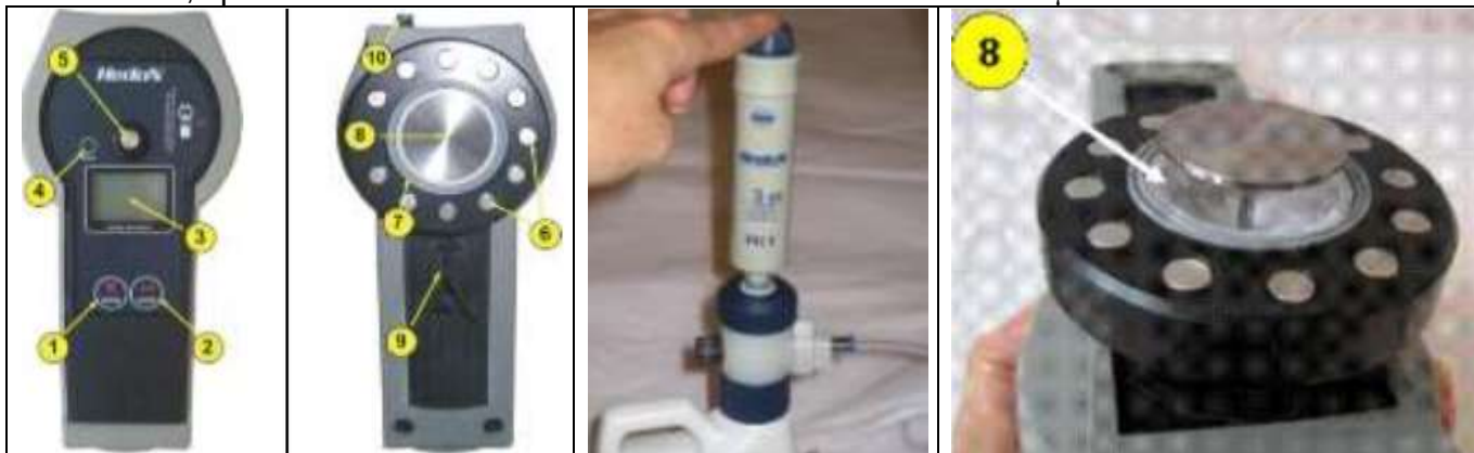
1. Botão MENU; 2. Botão ENTER; 3. Tela LCD; 4. LED verde/vermelho; 5. Pistão; 6. Ímãs para fixação sobre aço carbono; 7. Selo de silicone; 8. Êmbolo com 4 sensores de condutividade e 1 de temperatura; 9. Porta USB e carga da bateria; 10. Conector da mangueira de água deionizada.
