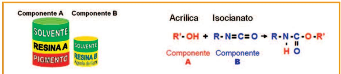
Figura 10 – Reação de polimerização da resina poliuretânica
