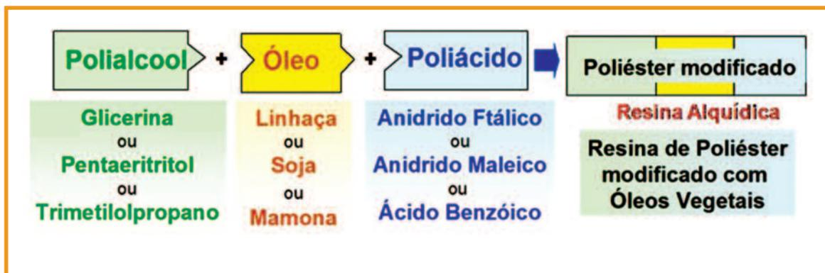
Figura 5 – Reação de obtenção da resina alquídica modificada com óleos vegetais
