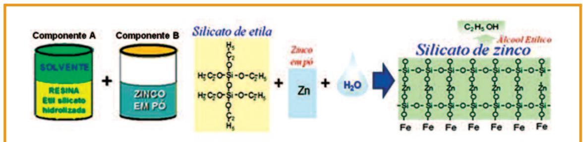
Figura 11 – Cura por hidrólise (reação do Silicato de Etila com o Zinco e com a Água)
