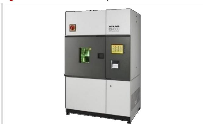
Figura 20 – Aparelho Weather-Ometer Ci 4000 (10)
