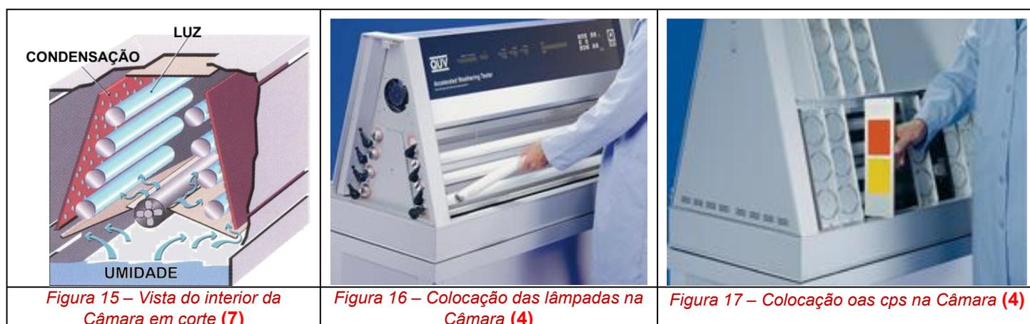
No espectro Eletromagnético, a faixa de radiação Ultravioleta vai de 250 a 400 nanômetros (nm), Nesta região são encontradas três tipos de radiações ultravioleta: UV-A, UV-B e UV-C sendo as mais importantes para o ensaio o UV-A e UV-B:
