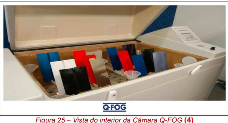
Figura 24 – Câmara Q-FOG para o ensaio Prohesion (4)
