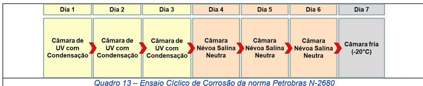
O ensaio deve ser iniciado pela etapa de exposição ao UVA e finalizado pela etapa de condensação. Entre a etapa de névoa salina e câmara de baixa temperatura, enxaguar os painéis de ensaio com água deionizada sem secá-los.
