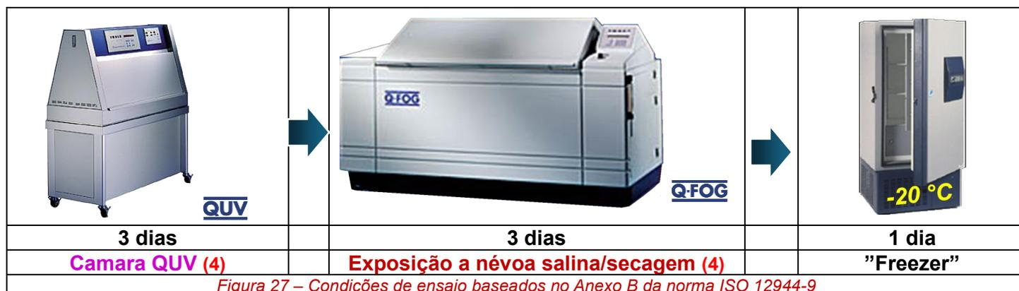
*Figura 27 – Condições de ensaio baseados no Anexo B da norma ISO 12944-9*
