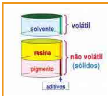
Figura 1 – Desenho esquemático da composição de uma tinta anti-corrosiva
