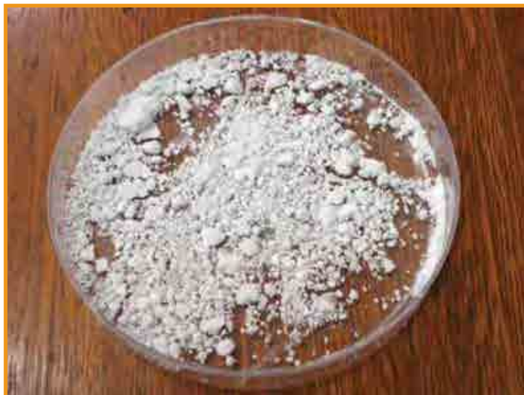
Figura 2 – Produto final (pó) obtido através do método de encapsulamento por extração de solvente de uma emulsão múltipla
