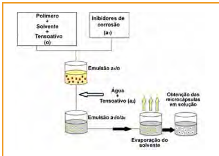
Figura 1 – Representação do método de encapsulamento por extração de solvente de uma emulsão múltipla (Adaptado de Benita, 2006) 9
