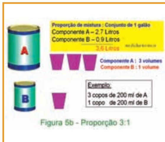
Figura 5 – Preparação de pequenas quantidades em que a tinta não será usada completamente
