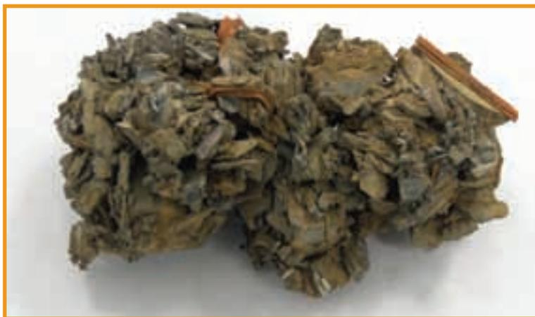
Figura 3 – Ímã completamente desintegrado
