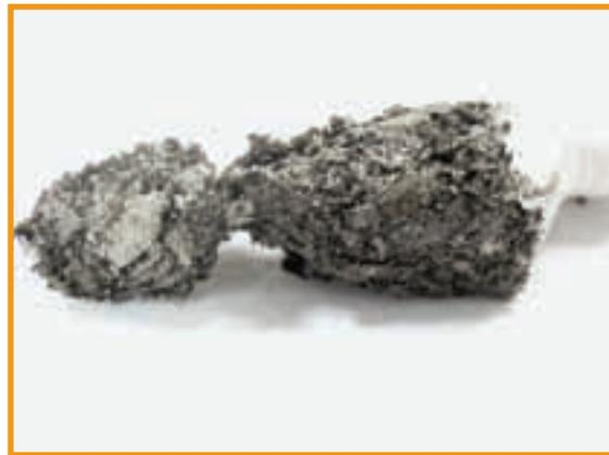
Figura 13 – Aspecto do ímã após o ensaio de indução de hidrogênio, mostrando a desintegração completa do material
