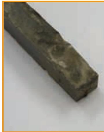
Figura 2 – Ímã com processo de danificação, mas sem produtos de corrosão aparentes
