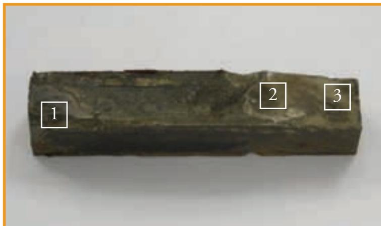
Figura 6 – Amostra com danificação. Regiões analisadas por EDS os resultados encontrados
