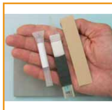
1. Kit com o tubo de água deionizada (0,6 mL), a tira de medição, e a fita adesiva
