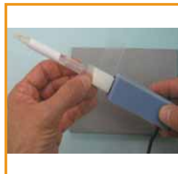
4. Ligue o Elcometer 130, coloque o disco na parte central do aparelho e aperte o botão verde de leitura
