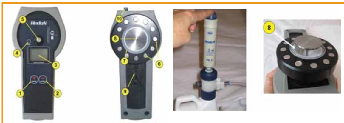
1. Botão MENU; 2. Botão ENTER; 3. Tela LCD; 4. LED verde/vermelho; 5. Pistão; 6. Imãs para fixação sobre aço-carbono; 7. Selo de silicone; 8. êmbolo com 4 sensores de condutividade e 1 de temperatura; 9. Porta USB e carga da bateria; 10. Conector da mangueira de água deionizada. (12)
