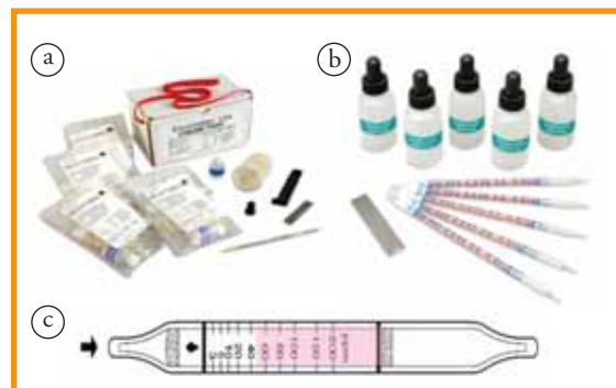
Figura 3 – Kit Chlor-test (a) e kit para teste de íon cloreto da Elcometer (b) e tubo de titulação Kitagawa (c) (8)
