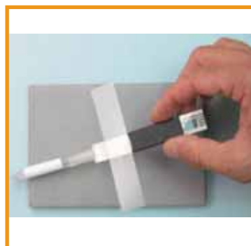
2. Afixa-se a tira com a fita adesiva e depois espreme-se o tubo para produzir um fluxo de água
