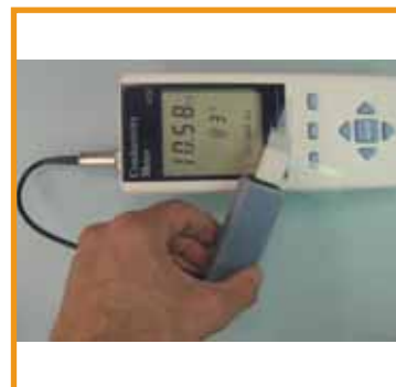
Figura 8 – Procedimento de utilização da Tira de Medida de Salinidade (Salt Measuring Strip)
