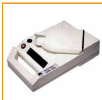
4. Ligue o Elcometer 130, coloque o disco na parte central do aparelho e aperte o botão verde de leitura
