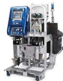
Airless Bicomponente Automático
