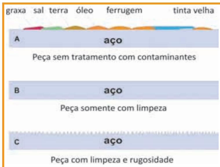
Figura 2 – Ilustração de aspectos superficiais de substratos de aço
