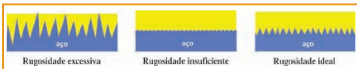
Figura 5 – Comparação entre perfis de rugosidade
