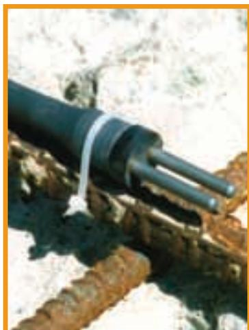
Figura 6 – Sensor 800 (COR-RATER Probe, Model 800) posicionado sobre a armadura.
