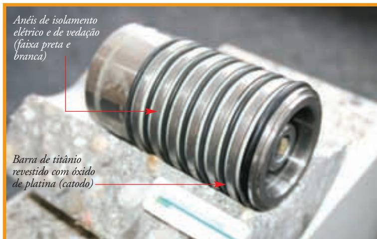
Figura 3 – Sensor de anéis expansivos (*Expansion Ring Anode*).
