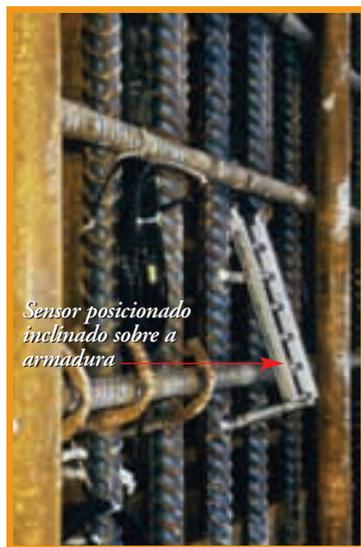
*Figura 4 – Sensor escada (Anode Ladder) sobre a armadura, em posição inclinada. Fonte: Sensortec*
