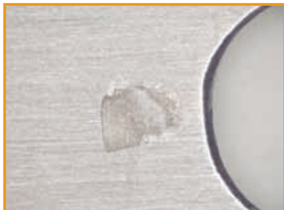
Figura 2 – Fotos do corpo de prova AISI 316, com aumento de 20x (foto da esquerda) e 10x (foto da direita), na lupa, após término da primeira etapa
