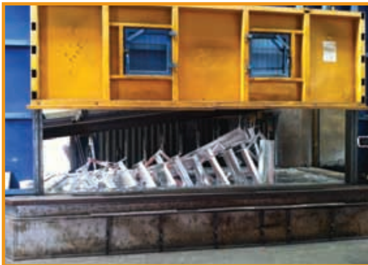
Figura 3 – Exemplo de sustentação de materiais a serem galvanizados
