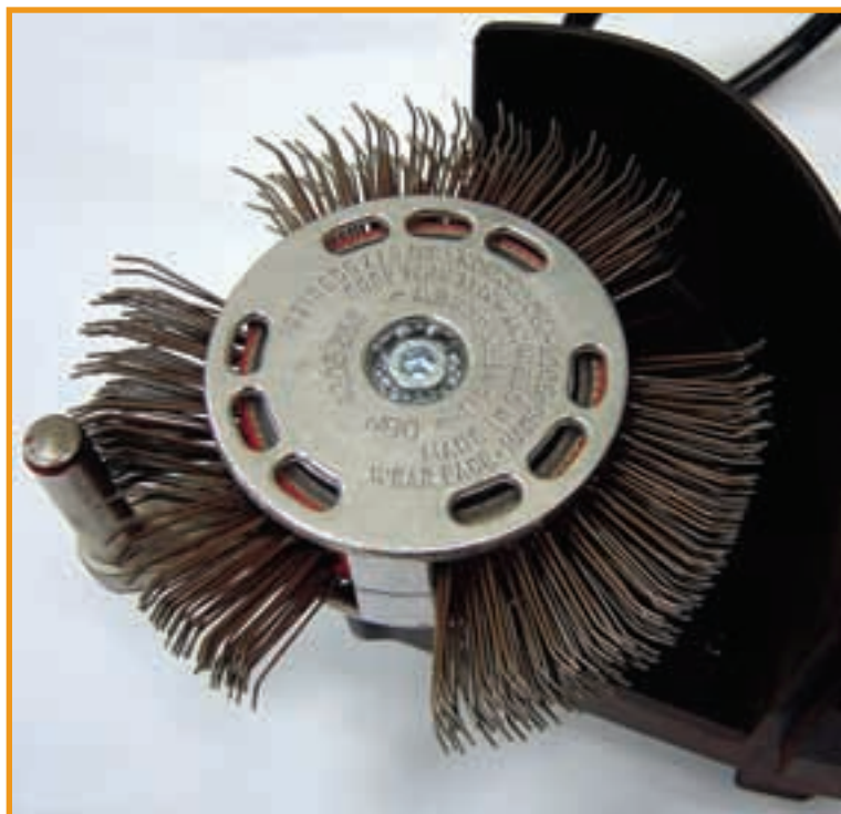
Figura 3 – Máquina Monti (Bristle Blaster), usada para obtenção do grau de limpeza SP 11
