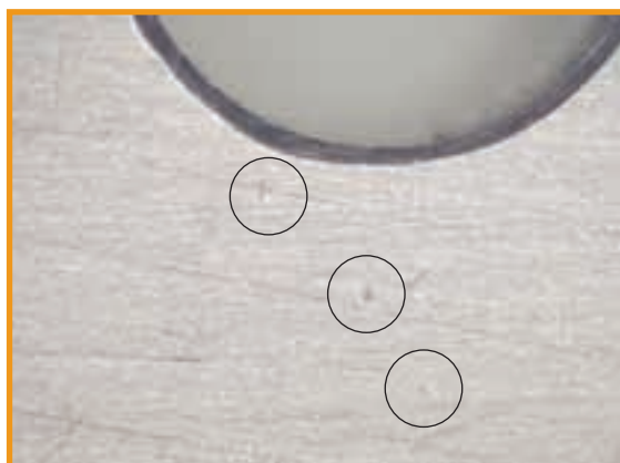
Figura 3 – Fotos do corpo de prova em liga 825, com aumento de 20x (foto da esquerda) e 10x (foto da direita), na lupa, após término da primeira etapa
