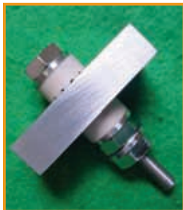
Figura 1 – (a) Suporte contendo os corpos-de-prova e seus respectivos dispositivos de frestas, (b) Detalhe da montagem do dispositivo de frestas no corpo de prova
