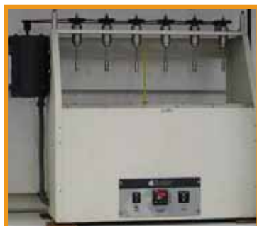
Figura 2 – Banho NACE – Equipamento onde é realizado o ensaio NACE
