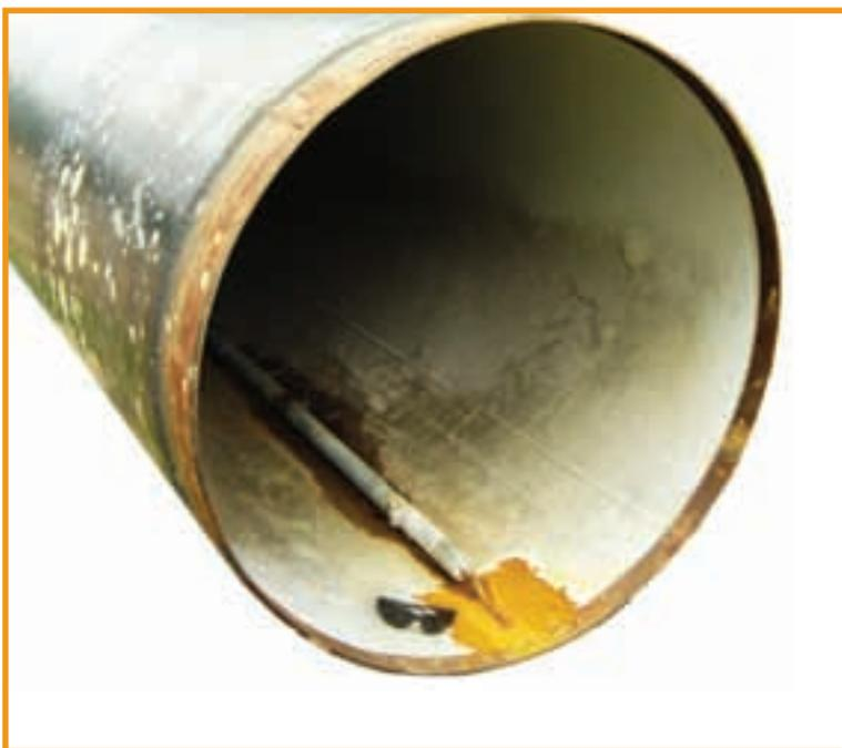
Figura 2 – Instalação de continodo em tubulação de petróleo
