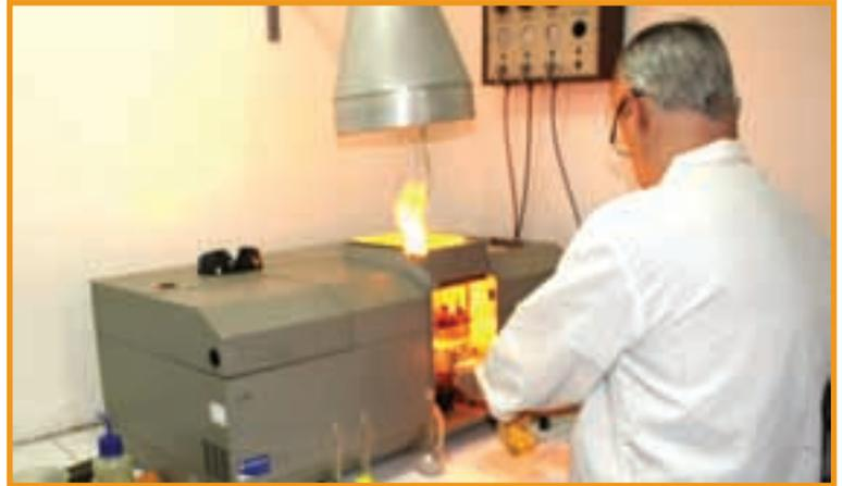
Espectrômetro de absorção atômica do laboratório de análises da CentralSuper
