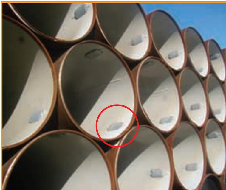
Figura 7 – Anodos tipo “linguado” em tubulação
