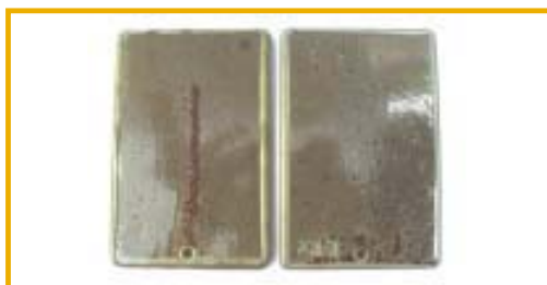
Figura 19 – Corpos-de-prova revestidos com RE após 3° ciclo completo do ensaio de corrosão
