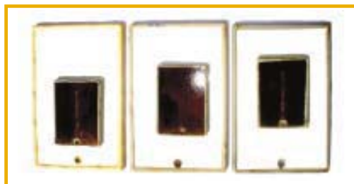
Figura 17 – Corpos-de-prova revestidos com RCP 15 min após 2° ciclo do ensaio de corrosão.
