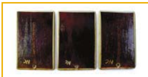
Figura 15 – Corpos-de-prova revestidos com RNC após 3° ciclo completo do ensaio de corrosão
