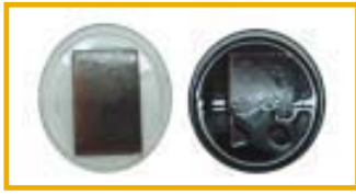
Figura 11 – Imersão do corpo de prova de aço carbono 1020 revestidos de RCP 15 min em óleo leve
