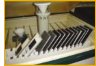
Figura 9 – Ensaio de corrosão em câmara de névoa salina das amostras de RNC, RE, RC 1,0% p/p HMTA e RCP 15 min
