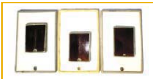
Figura 16 – Corpos-de-prova revestidos com RCP 15 min após 1° ciclo do ensaio de corrosão
