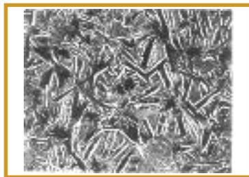
Figura 2 – Aspecto da camada de fosfato após 10 min de imersão num banho de fosfato à base de fosfato de zinco acelerado com nitrato. Este tempo é o valor máximo permitido. A camada apresenta grãos maiores do que a camada mostrada na Figura 1. Aumento 350x.
