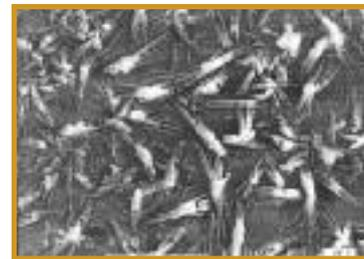
Figura 9 – Aspecto da camada de fosfato após 100 s de imersão no banho de fosfato de zinco acelerado com nitrato e nitrito. Pode-se verificar que a camada apresenta-se fechada e já está formada. Aumento 350x.
