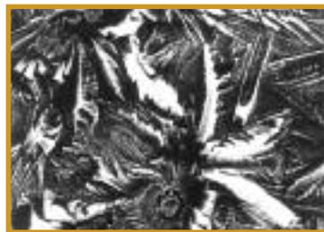
Figura 3 – Aspecto da camada de fosfato após 12,5 min de imersão num banho de fosfato à base de fosfato de zinco acelerado com nitrato. Este tempo é um valor acima da faixa operacional. Pode-se verificar que ocorreu um grande aumento do tamanho dos cristais de fosfato. Aumento 350x.
