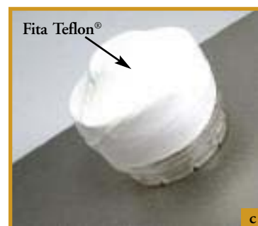
Figura 1 – Ilustração esquemática da montagem dos dispositivos formadores de frestas com o espaçador (a). Corpo-de-prova do aço inoxidável AISI 316L montado com o conjunto parafuso/porca/arruelas em aço inoxidável AISI 316, utilizado para fixar os dispositivos formadores de frestas em cada lado do corpo de prova (b) e (c).
