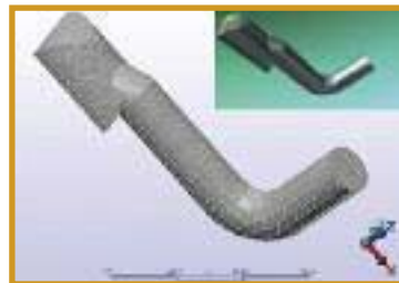
Figura 4 – Vista da geometria 3D do condensador e da tubulação de admissão
