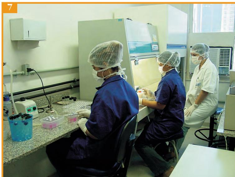
*Fig. 7 - LABIO: Análises microbiológicas para detecção e quantificação de bactérias redutoras de sulfato (BRS)*
