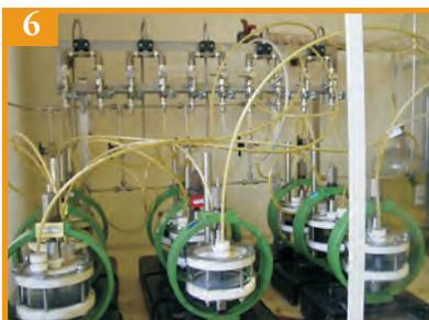
Fig. 6 - LAH<sub>2</sub>S: Ensaio de corrosão sob tensão induzida por sulfetos
