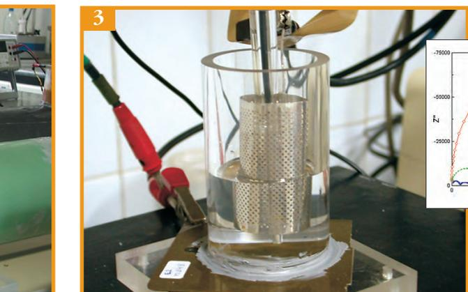
Fig. 3 - LACOR: Estudo da substituição de revestimentos à base do cromo hexavalente através da técnica de impedância eletroquímica
