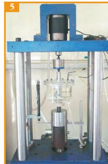
Fig. 5 - LAH<sub>2</sub>S: Ensaio de determinação da tenacidade à fratura de aços especiais
