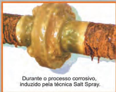
Durante o processo corrosivo, induzido pela técnica Salt Spray.
