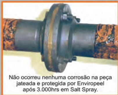
Não ocorreu nenhuma corrosão na peça jateada e protegida por Enviropeel após 3.000hrs em Salt Spray.
