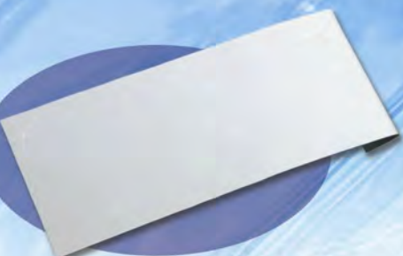
Zinko Triazol Super + Hessotop Hotstar 240 horas isento de corrosão branca *
