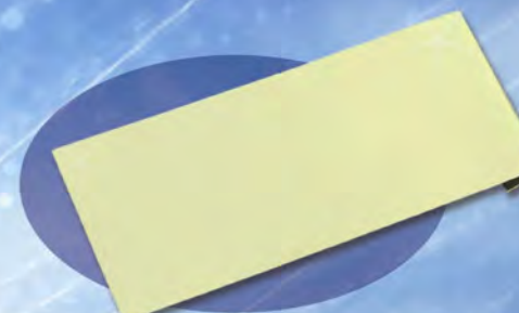
Hessopas GH Yellow + Hessotop Hotstar 360 horas isento de corrosão branca *
