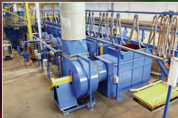
ELEVADOR DE CARGA/DESCARGA, RESFRIADOR DE PEÇAS PINTADAS E ESTUFA DE CURA
