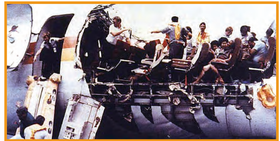
Aeronave do voo 243 da Aloha Airlines no aeroporto de Kahului em 28 de Abril de 1988, após sua fuselagem ser arrancada durante o voo.
