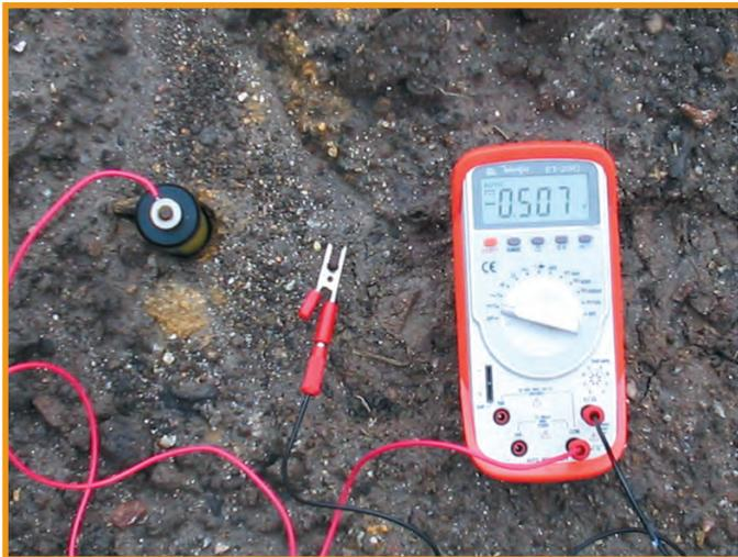
Fig. 1 - Dispositivos utilizados para medidas de potencial redox
