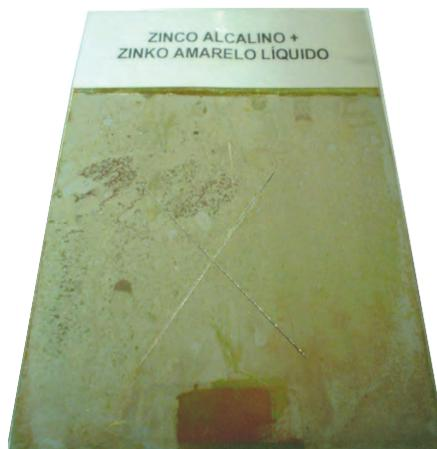
Corpo de prova submetido a 96h de Salt Spray
