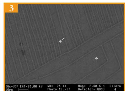
Podemos visualizar que após o Salt Spray<sup>3</sup>, o corpo de prova não apresenta qualquer sinal de corrosão, mesmo no ponto onde houve o corte, o que significa que houve a regeneração da camada.
