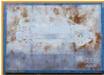
*Foto 2 - Fortes sinais de corrosão após um mês em exposição ao meio ambiente*
