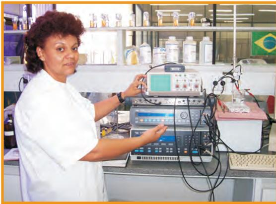
*Detalhe de um dos conjuntos potenciostato/ analisador de frequências*
