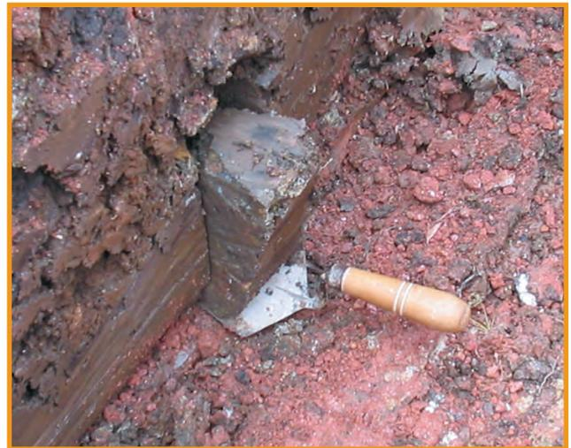
Fig. 2 - Coleta de amostra para determinação de índices de corrosidade
