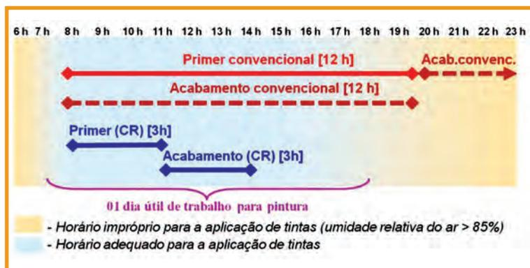
Figura 2 – Horários adequados e inadequados para aplicação de tintas
