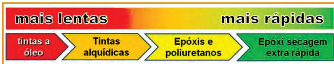
Figura 1 – Evolução da secagem ou da cura de tintas anticorrosivas
