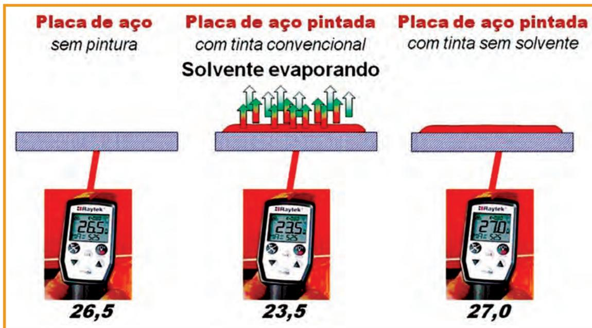
Figura 4 – Como a tinta epóxi convencional se compara a uma tinta epóxi sem solvente na aplicação
