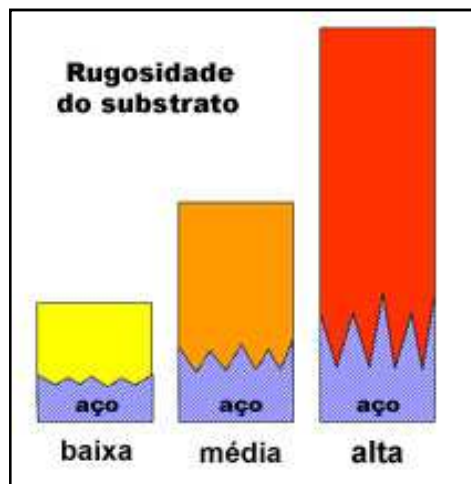
Figura 3 - Ilustração de um conceito utilizado com relação à espessura do revestimento x altura do perfil de rugosidade.
