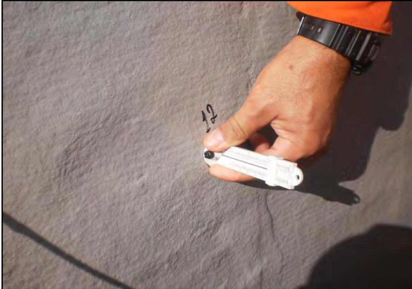
**Medição da Espessura Seca com Penetrômetro**
