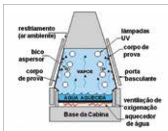
Figura 11 - Vista do interior da Câmara em corte (3)
