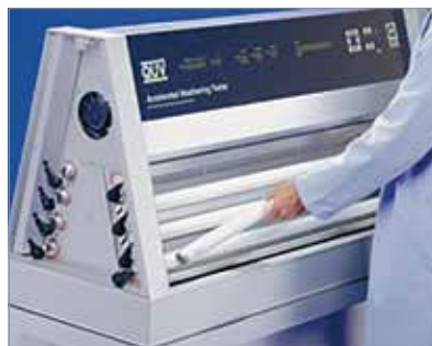
Figura 13 - Colocação das lâmpadas na câmara (3)
