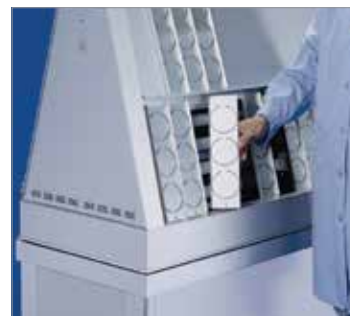
Figura 14 - Colocação dos cps na câmara (3)
