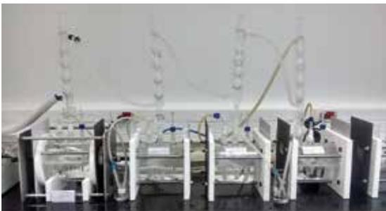
Figura 17 - Ensaios de Células Atlas.
