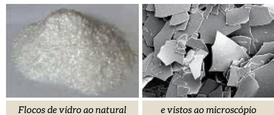
Figura 16 - flocos de vidro (*glass flakes*) (5)
