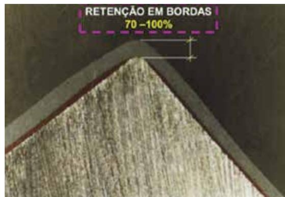
Figura 23 - Tinta moderna com alta retenção (8)
