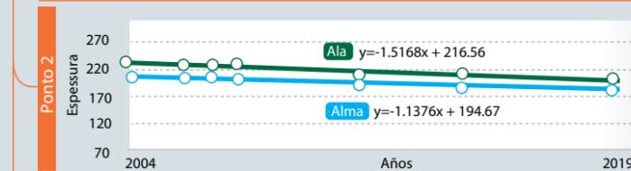
Ponto nº2 de medição: Coluna Suporte de efeito nº7, planta evaporadora evaporadora Linha II
