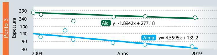
Ponto n°3 de medição: Coluna de precipitador (3° andar), Caldeira recuperadora Línea II.
