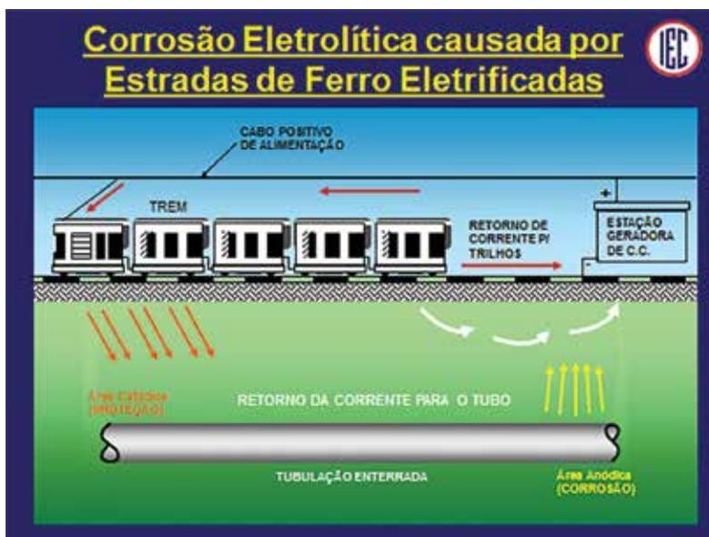
Fig. 03 - Esquema típico da interferência das estradas de ferro eletrificadas sobre dutos enterrados
