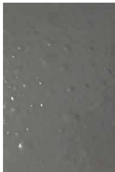
Figura 12 - Esquema EH - Imersão em água do mar sintética. Corpos de prova preparados na unidade de São Luís. Grau de empolamento 3(S5).
