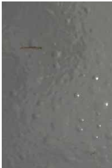
Figura 5 - Esquema EH - Imersão em água DI. Revestimento aplicado na unidade da Vale em São Luís. Grau de empolamento 3(S5).
