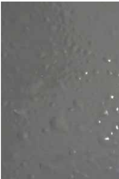
Figura 4 - Esquema IK - Imersão em água DI. Revestimento aplicado na unidade da Vale em São Luís. Grau de empolamento 4(S5).
