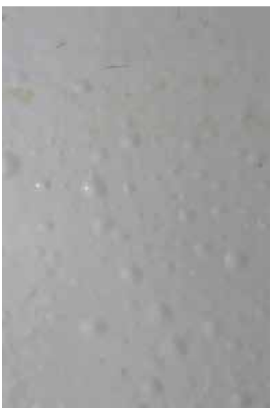
Figura 7- Esquema AD - Imersão em água DI. Revestimento aplicado na unidade da Vale em São Luís. Grau de empolamento 3(S5).
