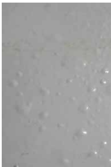
Figura 8 - Esquema BD - Imersão em água DI. Revestimento aplicado na unidade da Vale em São Luís. Grau de empolamento 2(S5).
