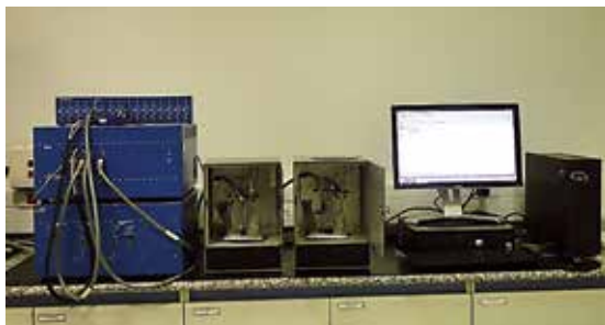
Figura 18 – Sistema utilizado para análise de OCP e EIS. Montagem dos eletrodos e do corpo de prova no interior da gaiola de Faraday e b) equipamentos utilizados: potenciostato, duas gaiolas de Faraday e computador..
