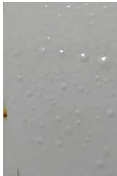
Figura 16 - Esquema BD - Imersão em água do mar sintética. Corpos de prova preparados na unidade de São Luís. Grau de empolamento 3(S4).
