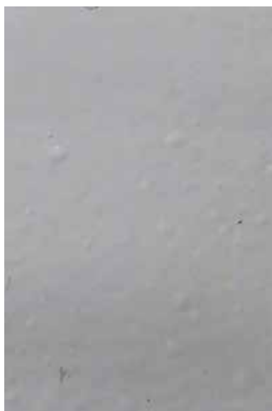
Figura 10 - Esquema JK - Ensaio de imersão em água do mar sintética. Corpos de prova preparados na unidade de São Luís. Grau de empolamento 2(S5).
