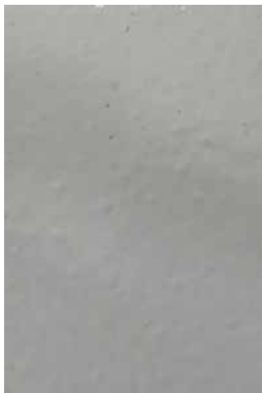
Figura 15 - Esquema AD - Imersão em água do mar sintética. Corpos de prova preparados na unidade de São Luís. Grau de empolamento 4(S4).
