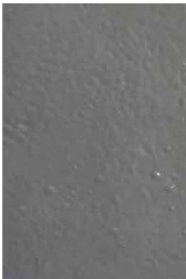
Figura 13 - Esquema GH - Imersão em água do mar sintética. Corpos de prova preparados na unidade de São Luís. Grau de empolamento 2(S4).
