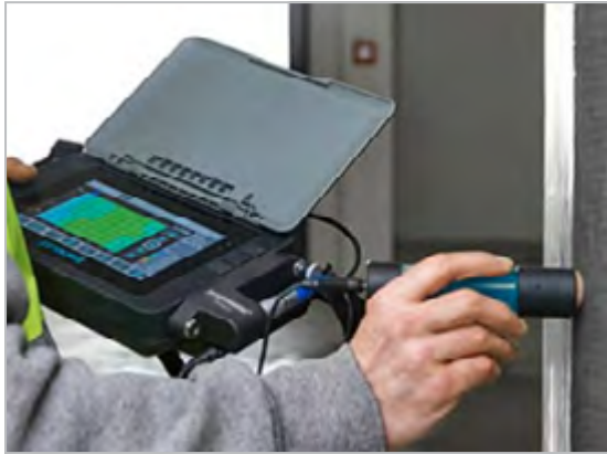
Figura 9- Medição de resistividade e permeabilidade em estrutura existente - Fonte: Cátolgo Proseq Brasil
