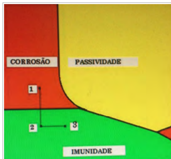
Fig 3 - Diagrama de Pourbaix - Equilíbrio do ferro na água a 25° C (simplificado)
