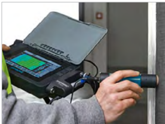
Figura 9- Medição de resistividade e permeabilidade em estrutura existente - Fonte: Cálculo Proseq Brasil
