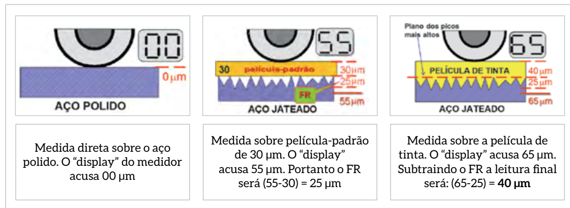
Figura 2 – Ilustração do procedimento para medidas de espessura abaixo de 40 \mu\text{m}
