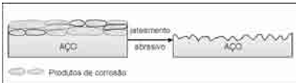
Figura 15. Representação esquemática da eficiência do jateamento abrasivo.
