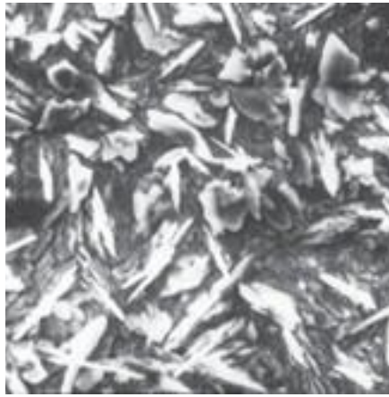
Figura 18. Aspecto de uma superfície ferrosa, após tratamento de fosfatização com fosfato de zinco (1000x)
