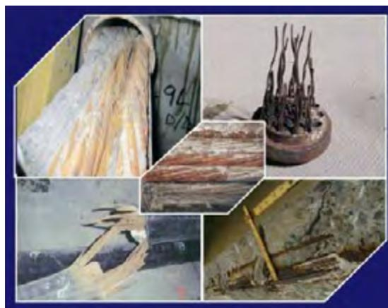
Figura 3: Cabos Pós-Tensionados com Problemas Sérios de Corrosão, Situação Comum de ser Encontrada e Pontes e Estruturas em Operação.
