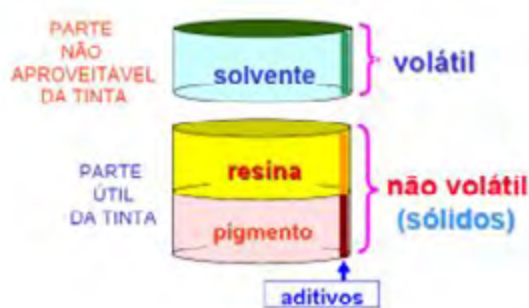
Figura 1. Representação da relação dos sólidos por volume em uma tinta (Fonte: GNECCO, 2013).
