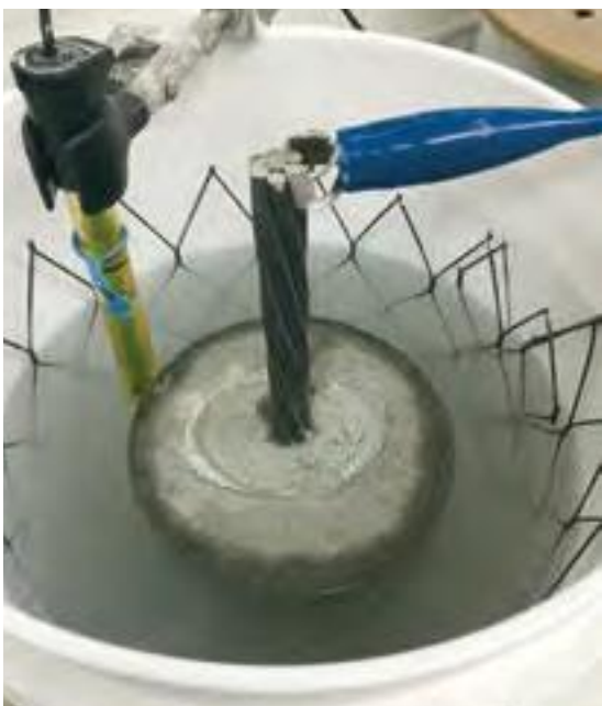
Figura 10: Teste Potenciostático de Corrosão para Comprovar a Eficiência do Fluido de Impregnação dos Cabos Pós-Tensionados
