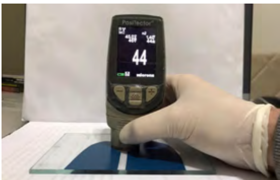
Figura 7. Leitura da espessura da amostra (Fonte: Arquivo pessoal).
