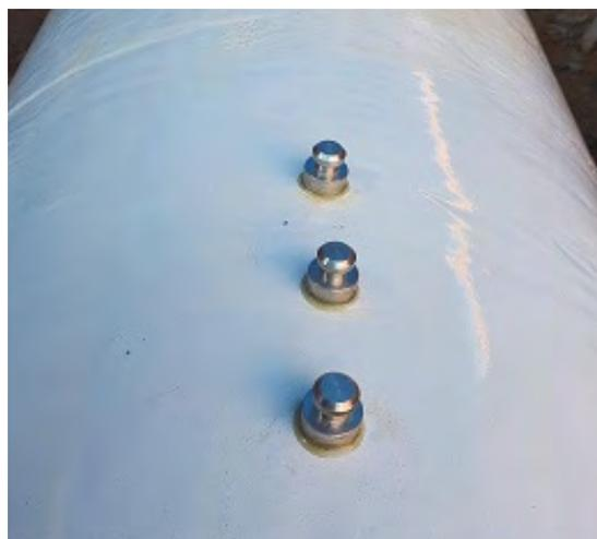
Fig. 02 - Área de ensaio com pinos colados com adesivo
