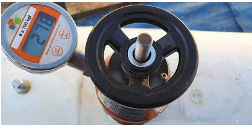
Fig. 04 - Dispositivo de ensaio de acionamento manual
