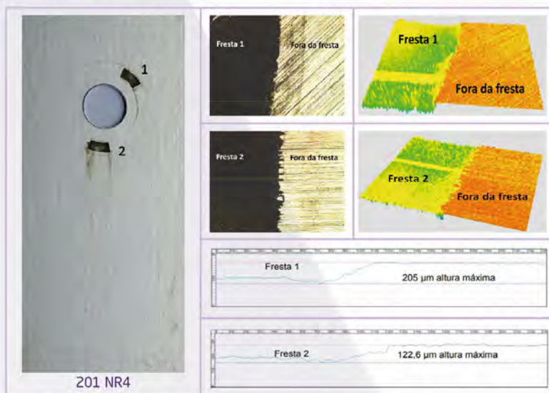
Figura 2 - Resultado de análise em microscópio confocal para o aço inoxidável 201
