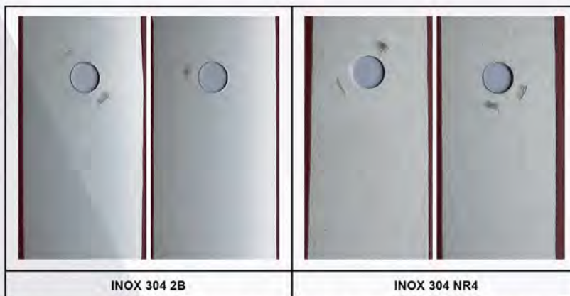
Figura 2 - Intensidade de corrosão por frestas nos corpos de prova dos aços inoxidáveis AISI 304 (UNS S30400) nos acabamentos 2B e NR4 após ensaio de imersão em vinagre + 3,5% NaCl após 44 dias.
