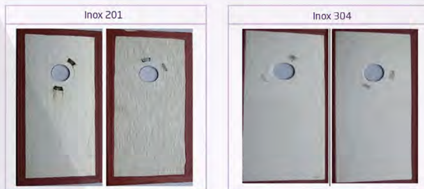
Figura 1 - Intensidade de frestas nos corpos de prova após ensaio de imersão em vinagre + 3,5% NaCl após 44 dias.
