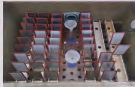
Figura 1 - Câmara de Névoa Salina (Salt Spray)
