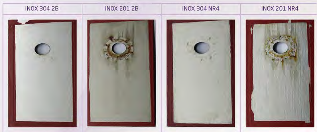
Figura 1 - Comparativo de Resistência à corrosão das amostras de Inox 304 x Inox 201.
