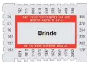
Figura 8 – Medidor de espessura úmida tipo pente, entalhado em chapa de alumínio
