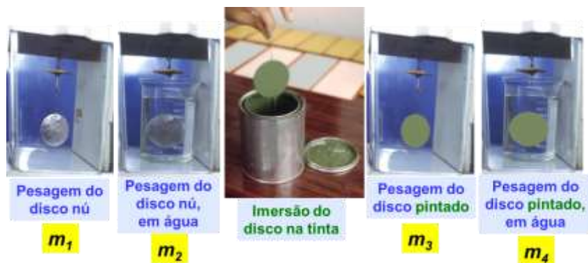
Figura 4 – Fotos da sequência de pesagens do disco em água e na tinta
