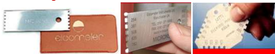
Figura 9 – Medidor pente de aço inoxidável
