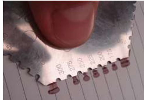
Figura 12 - Pente apertado contra o filme de tinta úmido e depois sobre folha de papel. A espessura é de 275 \mu\text{m}
