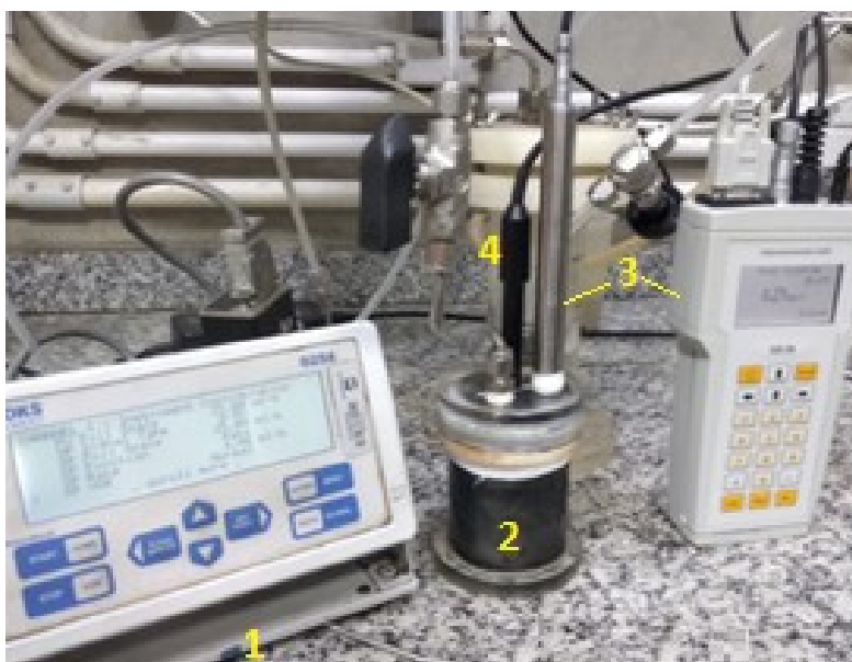
Figura 8 - Montagem do ensaio de dissolução \text{H}_2\text{S} com controle de fluxo. 1-Controlador de fluxo; 2-Célula de ensaio; 3-Sensor de \text{H}_2\text{S} ; 4-Sensor de pH e temperatura
