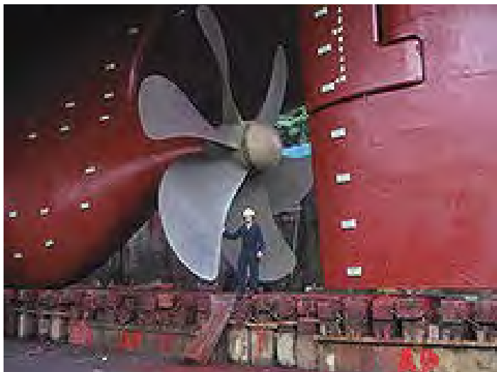
Fig. 05 – Os navios e embarcações de pequeno porte são protegidos com sistemas galvânicos, com a utilização de anodos de Zinco (ABNT NBR 9358) ou de Alumínio (ABNT NBR 10387), conforme exigências da ABNT NBR 7415 (Proteção Catódica de Embarcações Durante a Construção). Nas proximidades do hélice e do leme há necessidade da previsão de uma maior concentração de anodos, devido às condições adversas desses locais (par galvânico aço/cobre e grande agitação da água).
