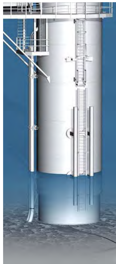
Fig. 08 – As fundações das torres eólicas instaladas no mar são protegidas com o auxílio de anodos galvânicos de liga de Alumínio (ABNT NBR 10387).
