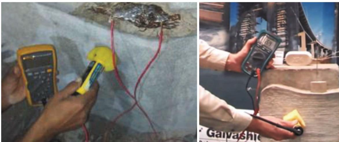
Figura 5 e 6 - Medição do potencial da armadura com sistema de proteção catódica instalado, realizando um acesso na face do concreto para obter contato com a armadura.
