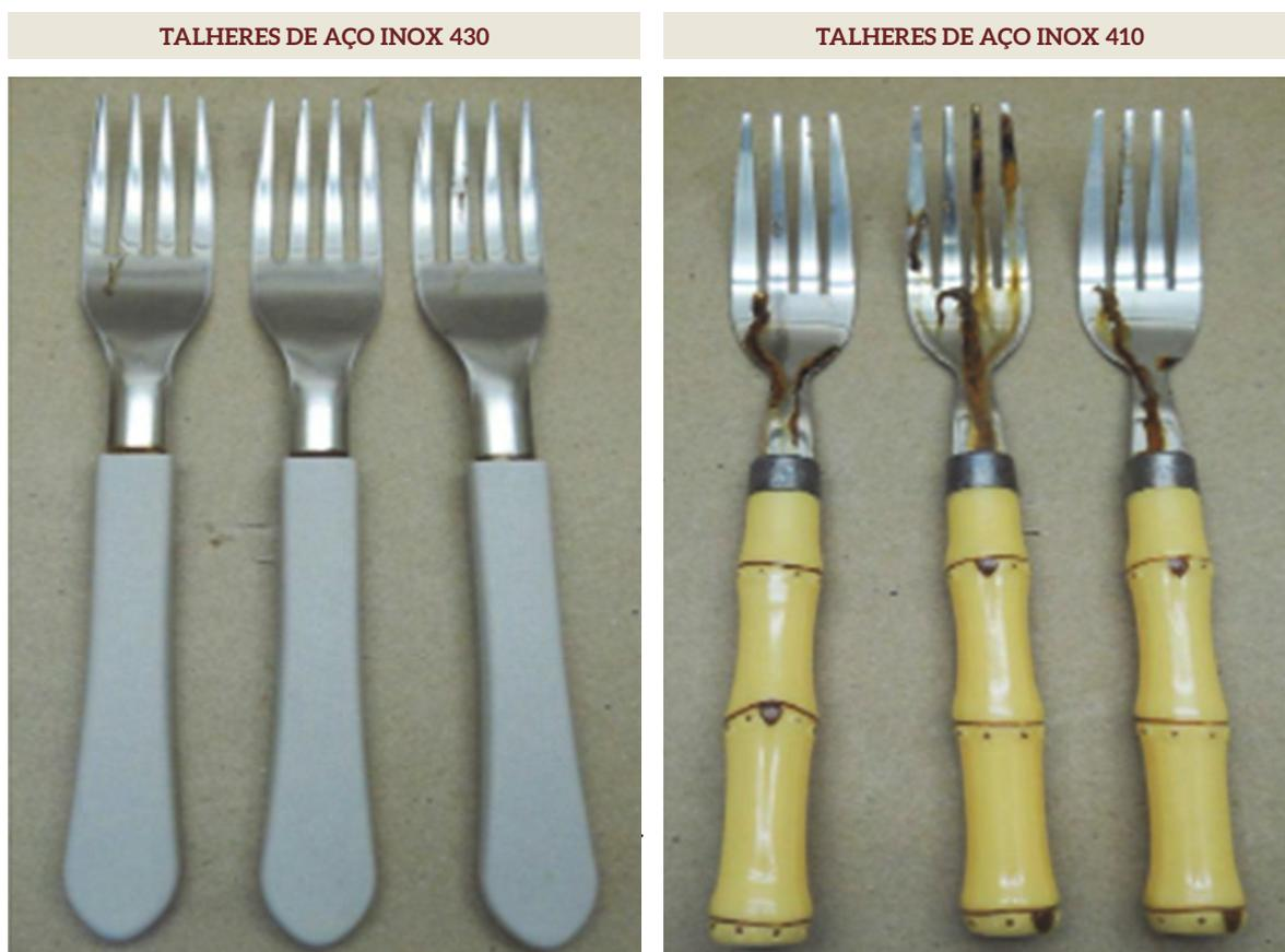
Figura 7 - Talheres de 430 e 410 após ensaio de Névoa Salina.
