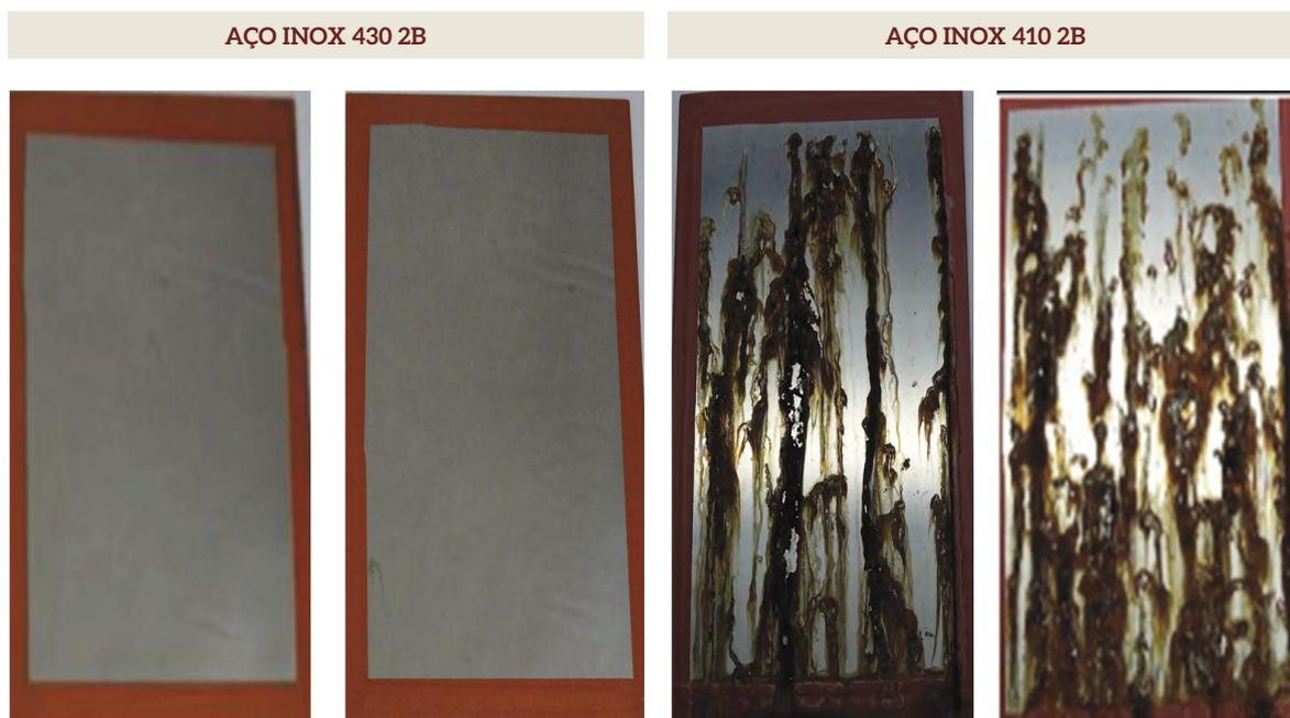
Figura 2 - Aspecto dos corpos de prova dos aços 430 2B e 410 2B, ensaiados após 30 dias de exposição em câmara de névoa salina.
