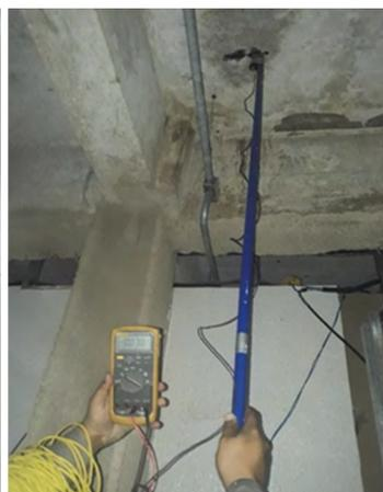
Figuras 3 e 4 - Medição do potencial de corrosão da armadura utilizando um eletrodo de referência de  $\text{Cu}/\text{CuSO}_4$ , realizando um acesso na face do concreto para obter contato com a armadura. Fonte: Imagens cedidas pela empresa IEC Engenharia.
