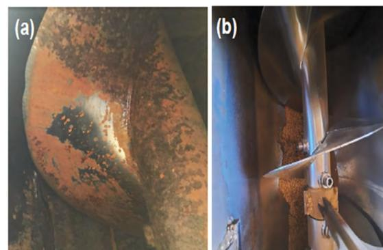
Figura 2. Rosca helicoidal (a) em aço carbono totalmente corroída e (b) rosca em aço inox 410 ainda brilhante após período de utilização.
