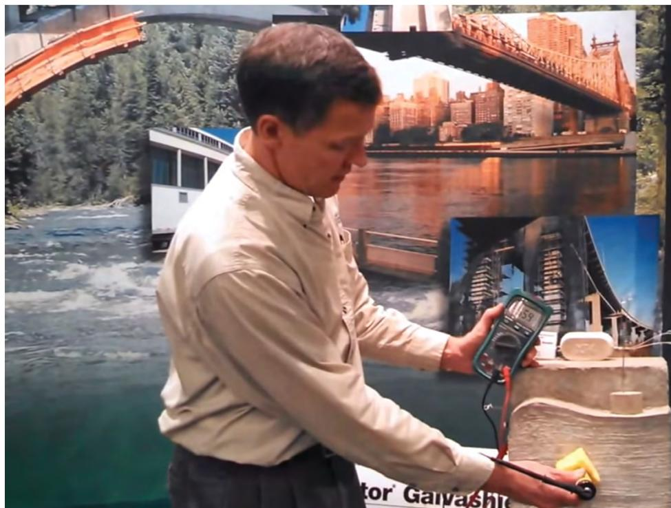
Fig. 06 - Medição de potencial das armaduras em relação ao concreto com o auxílio de um voltímetro de alta impedância e um eletrodo de referência de  $\text{Cu}/\text{CuSO}_4$ . Mediante interpretação dos valores medidos consegue-se mapear as regiões de corrosão ativa e definir os locais para o embutimento dos anodos galvânicos Galvashield CC, sem a necessidade de quebrar o concreto.
