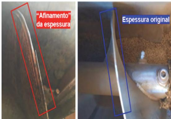
Figura 3. Extremidade da (a)rosca de aço carbono com desgaste severo e (b)rosca de inox com espessura preservada e aspecto ainda brilhante após período de uso.
