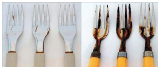
Esse ensaio compara a resistência à corrosão relativa dos aços na presença de cloreto. A Figura 2 apresenta o aspecto dos corpos de prova depois de 30 dias de exposição.
