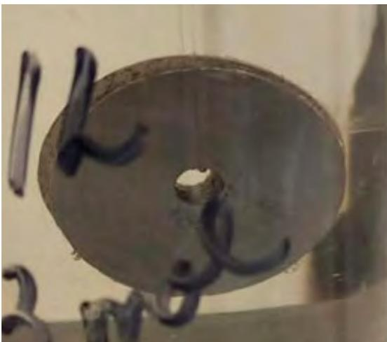
Figura 6 - Corpo de prova imerso em solução de chá branco  $5,0 \text{ g.L}^{-1}$  e  $HCl$   $0,3 \text{ mol.L}^{-1}$
