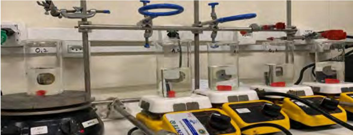
Figura 2 - Arranjo experimental para ensaios da perda de massa
