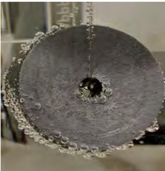
Figura 3 - Formação do gás H<sub>2</sub> na superfície metálica
