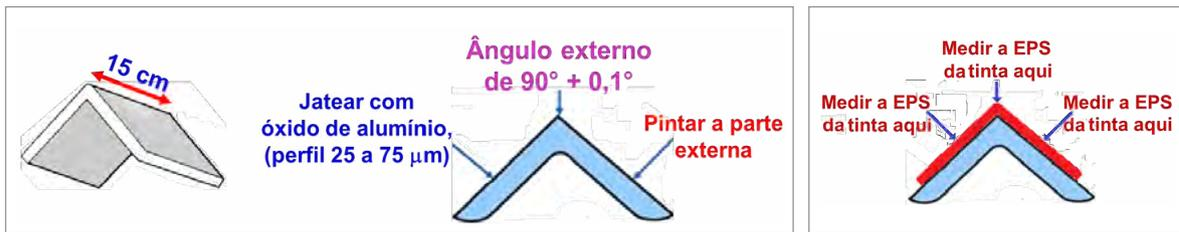
Figura 21 – O desenho mostra como é o teste segundo MIL-PRF 23236 D (EPS = Espessura da Película Seca)
