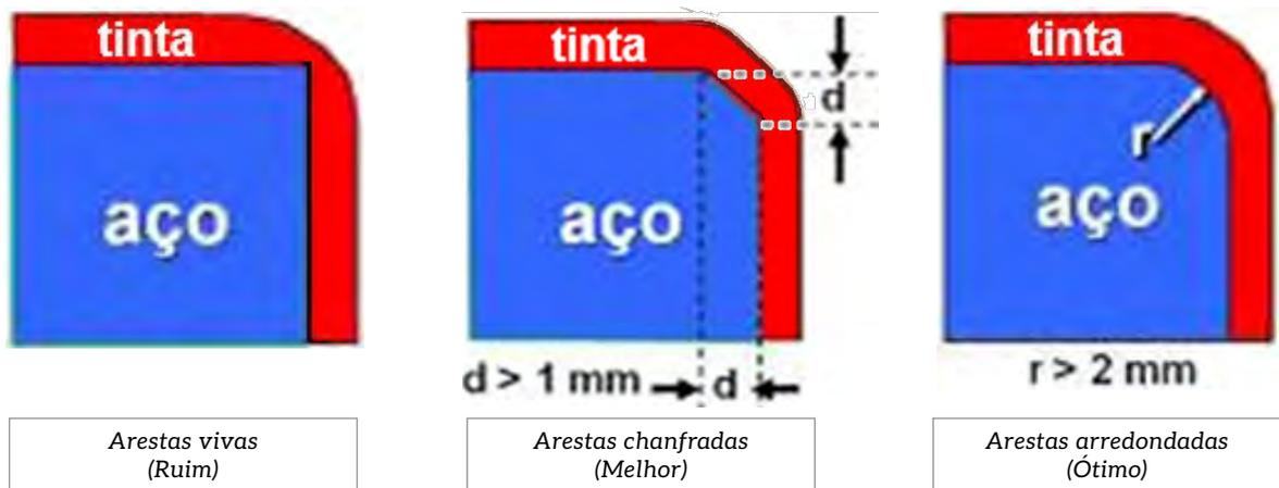
Figura 6 - Desenhos da norma ISO 12944-3 mostrando a chanfradura e o arredondamento
