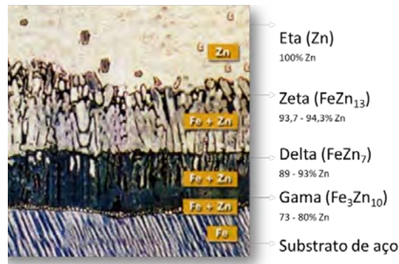
Figura 5: Camadas intermetálicas de zinco com variação na concentração de zinco e ferro até a camada superior composta 100% de zinco [8]
