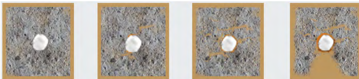
Figura 7 – Mecanismo de formação dos produtos da corrosão gerando primeiros pontos e fissuras até desprendimento do concreto e exposição do vergalhão. [11]
