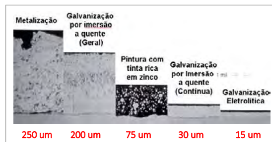
Figura 9 – Comparativo de espessura de revestimentos de Zinco
