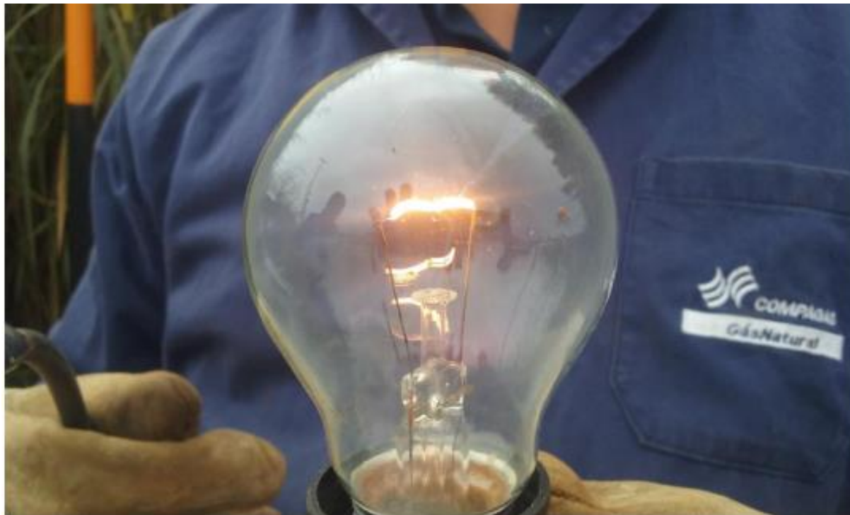
Figura 4 - Lâmpada conectada ao duto e ao terra remoto.
