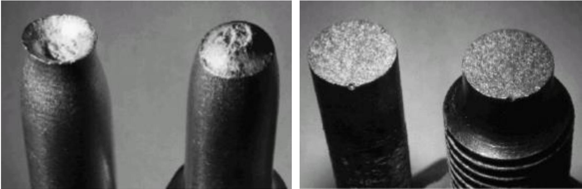
Fratura dútil x Fratura frágil
