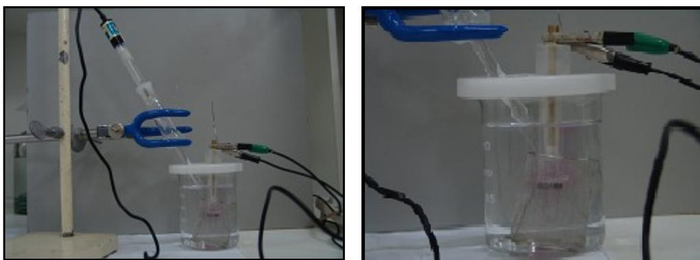
**Figura 8** - Célula eletroquímica utilizada nos ensaios de voltametria cíclica.
