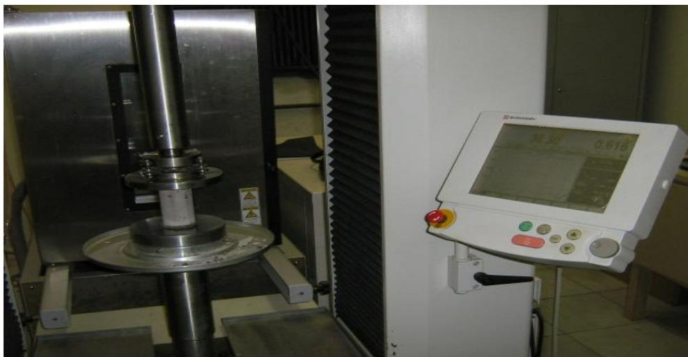
**Figura 7-Ensaio de resistência à compressão em corpo-de-prova**
